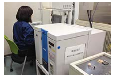
蛍光X線分析装置で重金属の有無を確認
