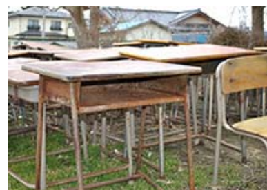
一度海水につかってしまった机やイスは、洗っても時間が経つとサビてしまう。
