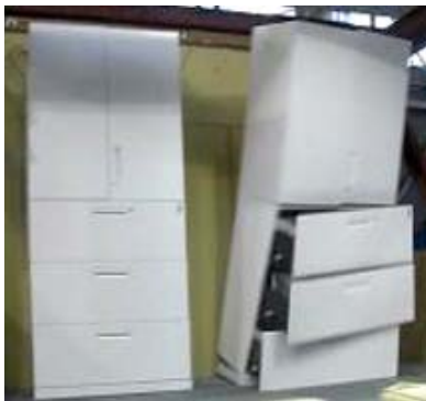
震度6強相当 左:壁固定有 右:壁固定無
