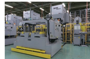
10種以上の金型を自動的に取り替えながら加工するプレス機は、「変種変量生産」に欠かせないインテリジェントな設備だ。
