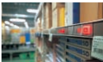
棚の赤ランプが点滅してピッキングすべき商品を示す。品番確認などの手間を無くすことで作業速度と精度を上げている。
