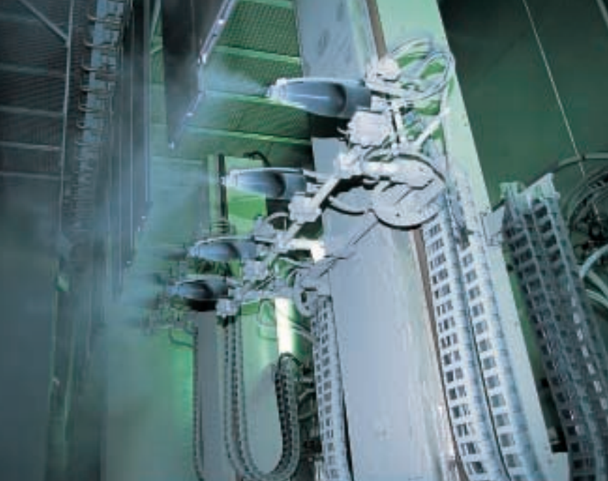
スプレーガンが上下して塗料を吹き付ける。壁には絶えず水が流れており、製品に付着しなかった塗料はこの水に溶けてタンクへと流れる。タンクで水と塗料に分離された後、水は再利用される。
