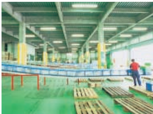
倉庫の上層でピッキングされたコンテナは自動的に下層へ運ばれ、検品したのちトラックに積み込まれる。
