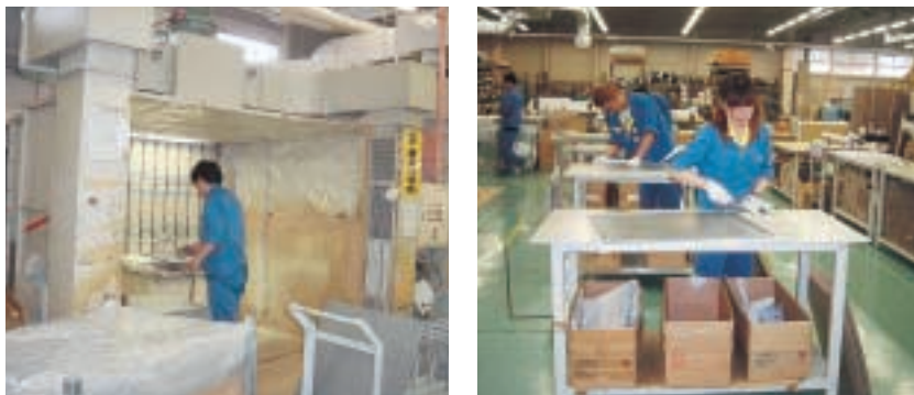
接着剤を吹き付けるブースとクロス貼り合わせ工程。トルエンが含まれない接着剤に変更。
