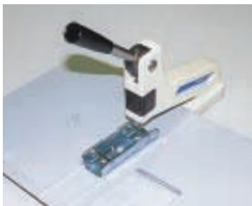
リベット留めは非常に強固なため、外し機も頑丈な作り。
