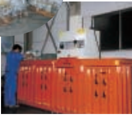
梱包などに使われたプラスチックはかさばるので圧縮機で圧縮。(八尾工場)
